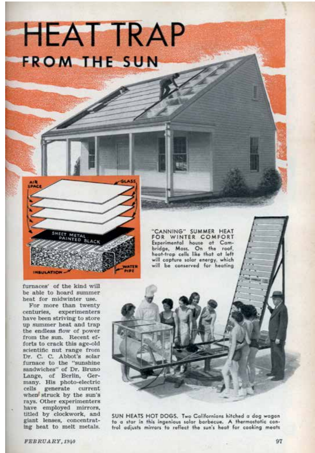
4 Konstruktiver solar-thermischer Kollektor für das M.I.T. Solar House I, 1939, aus: Popular Science, Februar 1940
